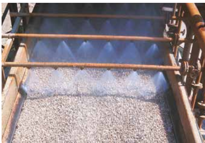
Lavage des granulats sous une rampe de jets d'eau
