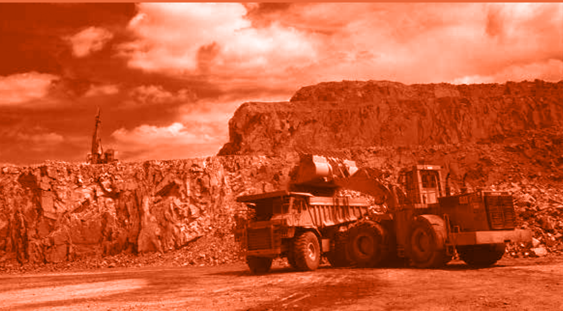
Chargement d'un dumper pour le transfert des granulats vers les installations de traitement
