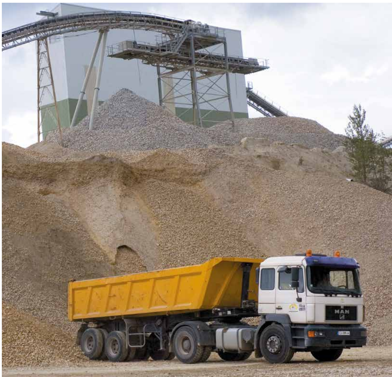
Reprise des granulats sur stock pour livraison par la route
