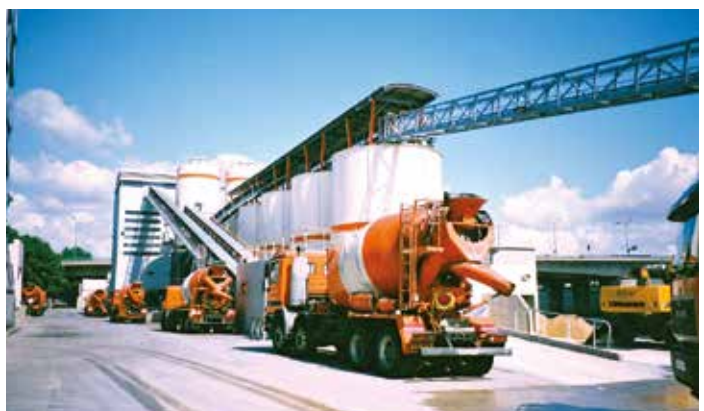
Camions toupies s'approvisionnant dans une centrale à béton
